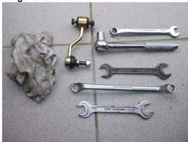
Eine neue Koppelstange mit dem benötigten Werkzeug (Standard)
