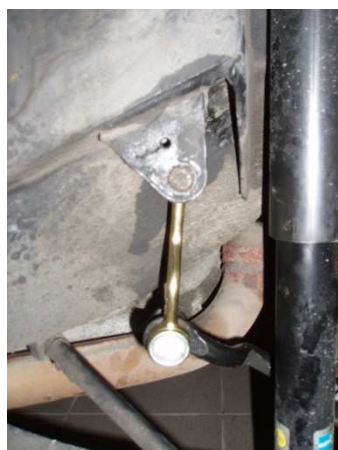
eingebaute neue Stange
