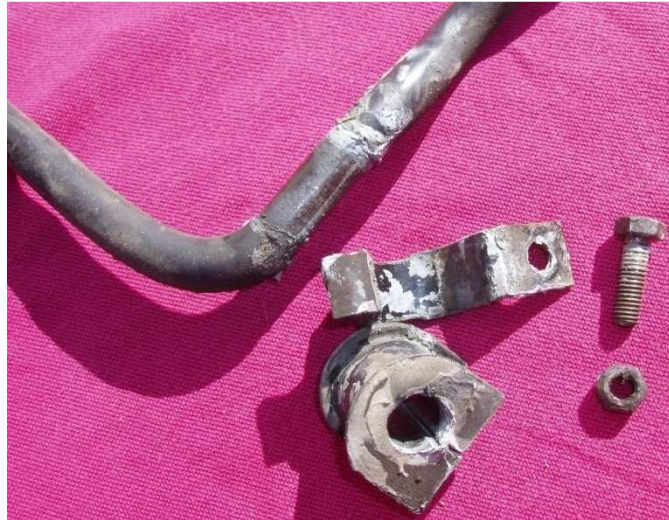
Stabilisator mit Befestigungsteilen einer Seite nach dem Ausbau. Im Foto ist die hellgraue Grafitpaste eines früheren Beruhigungsversuches zu sehen.
