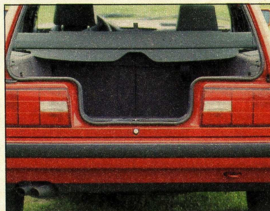
Sehr schmal wird die Ladeluke zwischen den Rückleuchteinheiten: Durch die 49 Zentimeter paßt gerade ein Kasten Bier
