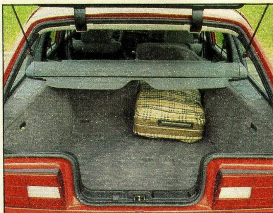
Die Ladekante befindet sich beim BMW 320i touring in 66 Zentimeter Höhe. Die Länge der Ladefläche beträgt maximal 1,54 Meter
