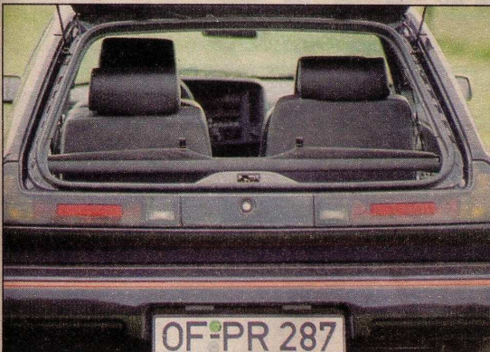
... die Ladekante befindet sich in luftiger Hüfthöhe von 84,5 Zentimetern. Die Ladeklappe ist mit 70,5 Zentimetern die schmalste
