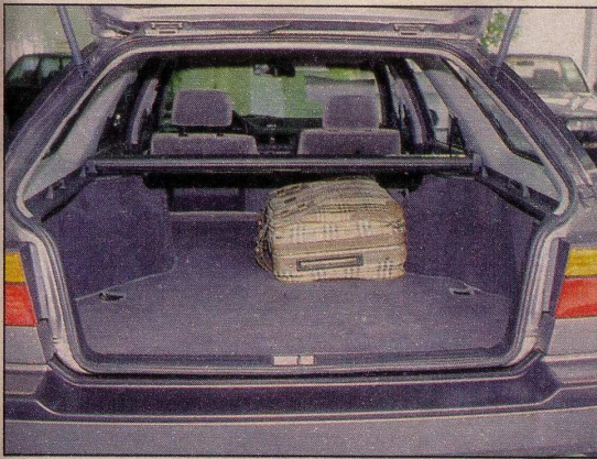
Niedrigste Ladekante beim Honda Accord AeroDeck: Sie liegt 59,5 Zentimeter hoch. Die Ladefläche mißt maximal 1,69 Meter
