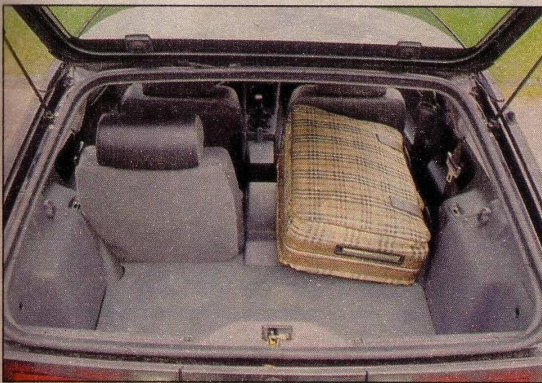
Die maximale Länge der Ladefläche des Volvo 480 turbo beträgt 1,26 Meter. Leicht zu beladen ist der Schwede nicht, denn ...
