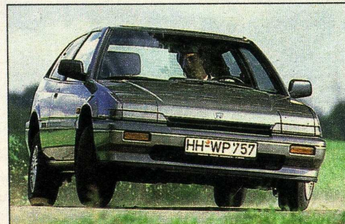
Untersteuert heftig: Honda. Seine Vorderräder drehen schnell durch. Kaum tückische Lastwechselreaktionen
