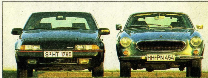
Clappscheinwerfer machen's möglich: Der neue Volvo (links) kommt praktisch ohne Kühlergrill aus, die Schnauze steigt ganz flach an. Das Vorbild, der P 1800, hatte noch ein richtiges „Gesicht“ mit zwei Rundscheinwerfern
